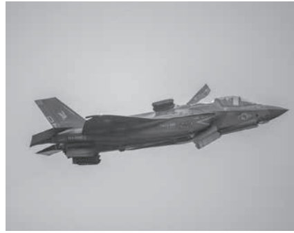
操縦席後方のリフトファンが特徴の海兵隊F-35B
